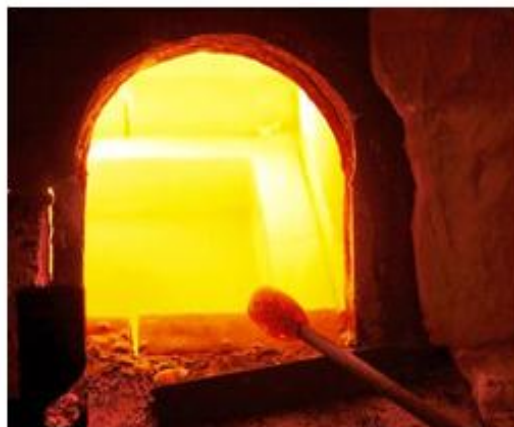
Tavenie surovín - sklárska pec
