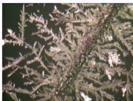
Obrázok 7 Tvorba striebra pod mikroskopom zdroj: http://www.prirodnejavy.eu/pokusy/priprava-krystalickeho-striebra.htm
