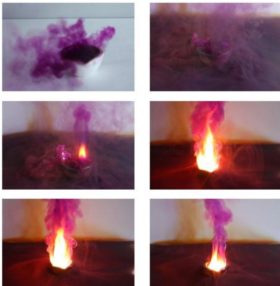
Obrázok 5 Zapálenie ohňa vodou zdroj: http://www.prirodnejavy.eu/pokusy/ohen-z-vody.htm
