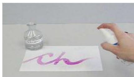
Obrázok 8 Vyvolanie fenolftaleínového tajného písma zdroj:
