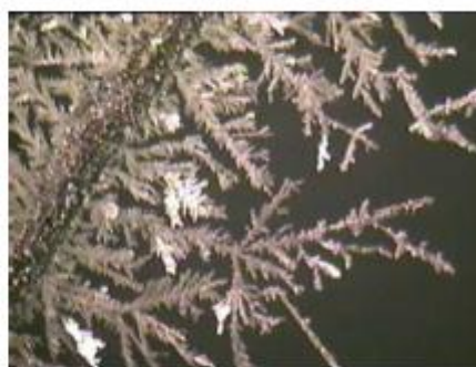
Obrázok 7 Tvorba striebra pod mikroskopom zdroj: http://www.prirodnejavy.eu/pokusy/priprava-krystalickeho-striebra.htm
