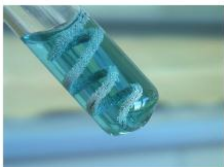
Obrázok 6 Vytváranie striebra na drôťku zdroj: http://www.prirodnejavy.eu/pokusy/priprava-krystalickeho-striebra.htm
