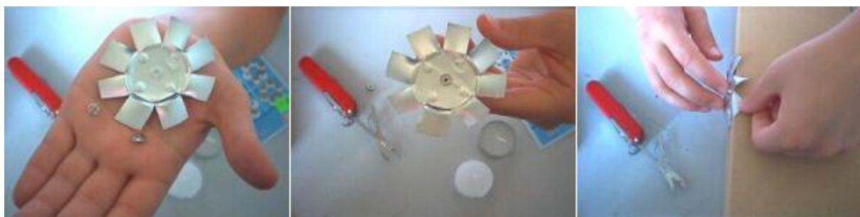
Na roztočenie vrtuľky použijeme zapálenú sviečku, ktorú vložíme na spodok stojana.
