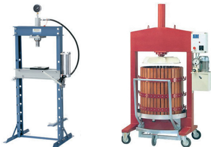
Obr. 130 Hydraulický lis: a) dielenský, b) potravinársky
