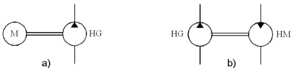
Obr. 31 Prenosový systém s tuhým nositeľom energie:
