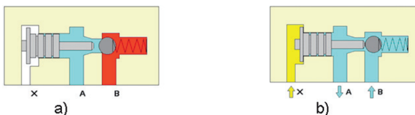
Obr. 70 Jednosmerný riadený ventil: a) neriadený stav, b) otvorenie nepriepustného smeru
