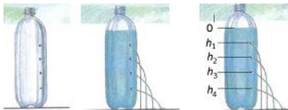
Obr. 8: Overenie domnienky o súvislosti hydrostatického tlaku s hĺbkou h v kvapaline
