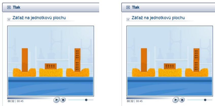
Obr. 2: Závislosť tlaku od dotykovej plochy a tlakovej sily
