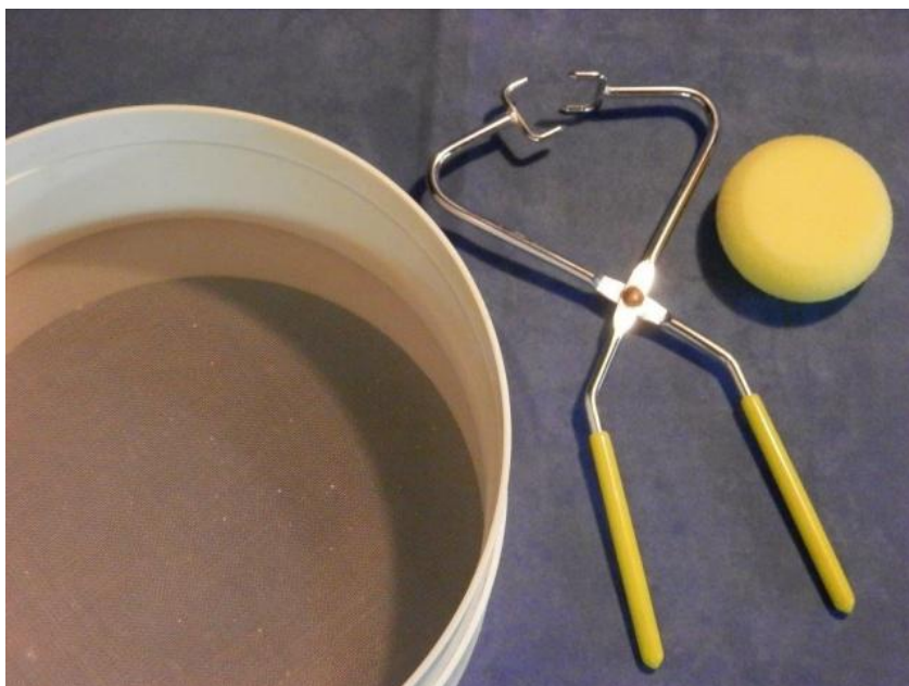
Nástroje na glazovanie: sito na preceďenie glazúry, glazovacie kliešte, hubka
