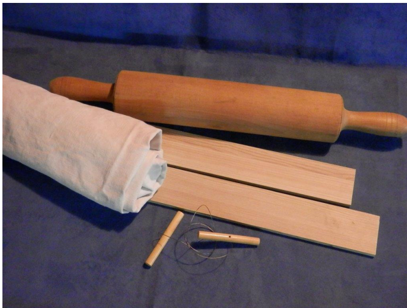
Nástroje na výrobu plátov: valček, vodiace lišty, struna, plátno
