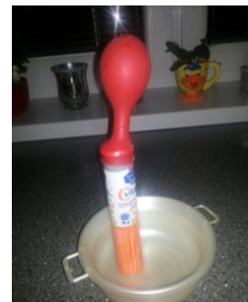
Obrázok 19 Nafúknutie balóna pomocou šumivých tabliet
