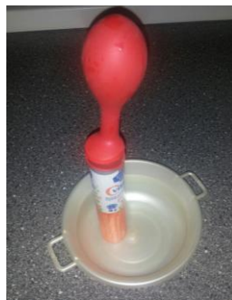
Obrázok 19 Nafúknutie balóna pomocou šumivých tabliet
