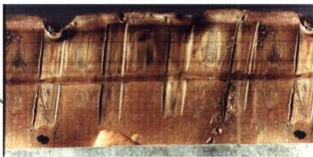
Obrázok 9 Strelofot; obraz povrchu strely na filmovej doske (zdroj: http://lnk.sk/a7U )
