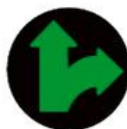
S 3c Kombinovaný signál so zeleným svetlom pre dva smery so znamením „Voľno“ (vzor)
