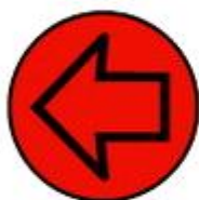
S 2a Signál s červeným svetlom pre jeden smer so znamením „Stoj!“ (vzor)
