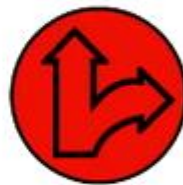
S 3a Kombinovaný signál s červeným svetlom pre dva smery so znamením „Stoj!“ (vzor)
