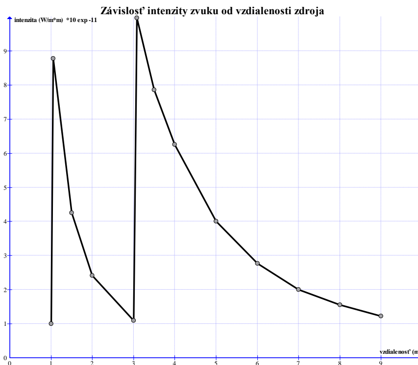
Graf 1 Závislosť intenzity zvuku od vzdialenosti zdroja – pôvodná verzia Prameň: vlastný návrh
