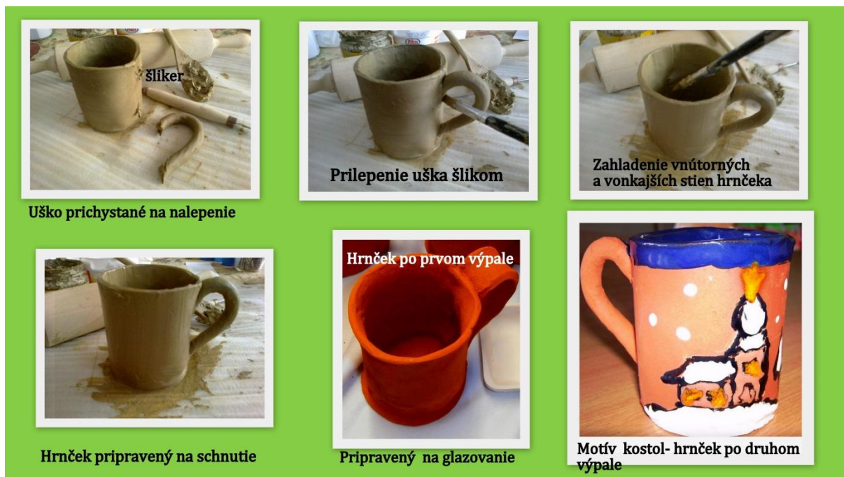
Obrázok 9 Postup výroby Vianočného keramického hrnčeka Prameň: vlastný návrh
