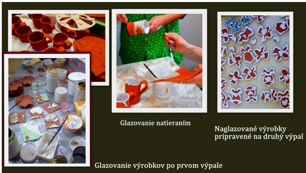
Obrázok 4 Povrchová úprava keramiky
