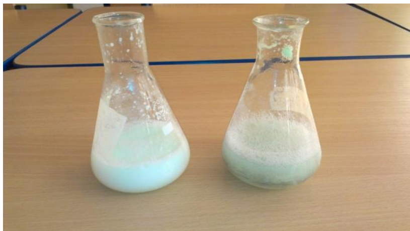
Obrázok 4: Rozdiel medzi tvrdou a mäkkou vodou
