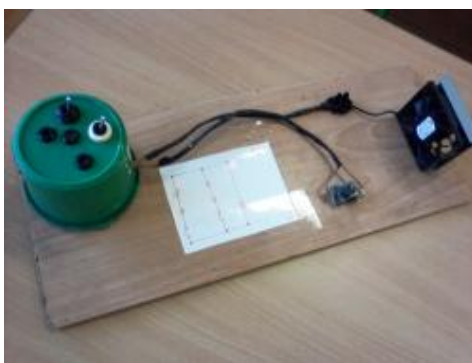
Obrázok 7 Ilustrácie žiackych výstupov: Obvod vyrobený žiakom, v ktorom je ako spotrebič zapojený elektromotor a tiež svetelné elektrospotrebiče.
