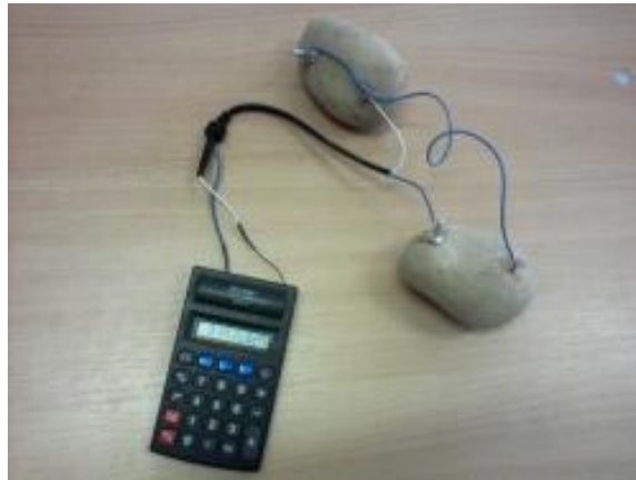
Obrázok 9 Ilustrácie žiackych výstupov: Elektrický článok vyrobený žiakom a jeho aplikácia pri napájaní kalkulačky.
