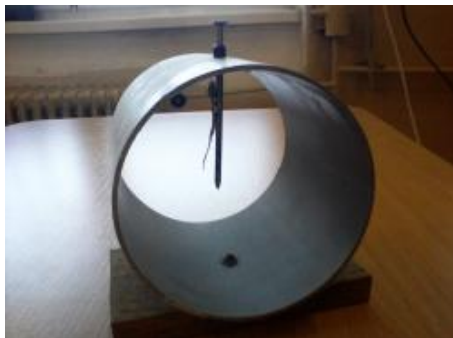
Obrázok 6 Ilustrácie žiackych výstupov: Elektrometer vyrobený žiakom schopný určiť prítomnosť elektrického náboja u telesa a jeho pomernú veľkosť.
