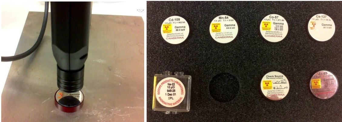
kalibrácia zariadenia na štandardné rádioaktívne žiariče s veľmi nízkou aktivitou
