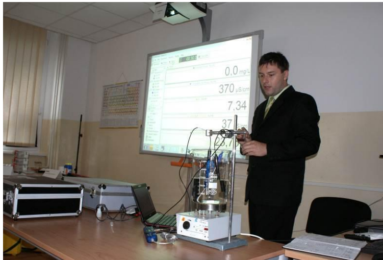
demonštrácia zmien teploty, pH, rozpustnosti a rozpusteného kyslíka v roztoku pri rozpúšťaní rôznych zlúčenín
