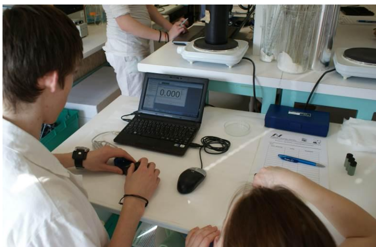
pred začatím merania sa prístroj vynuluje stlačením zeleného tlačidla na samotnom prístroji tak, že v optickej dráhe sa nachádza slepý pokus
