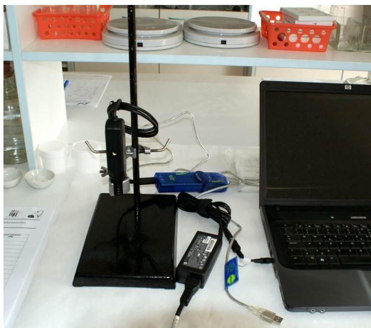
zapojenie Geiger-Müllerovho počítača do počítača
