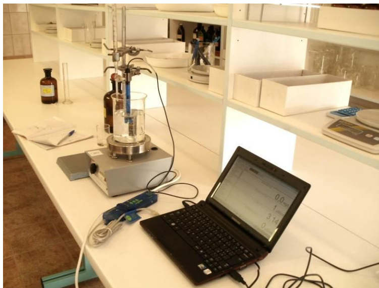
zostava na sledovanie pH a teploty
