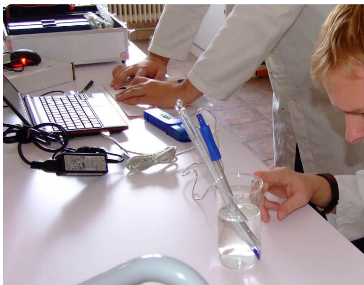
pred prácou je výhodné teplotný senzor nakalibrovat' pomocou overeného teplomera
