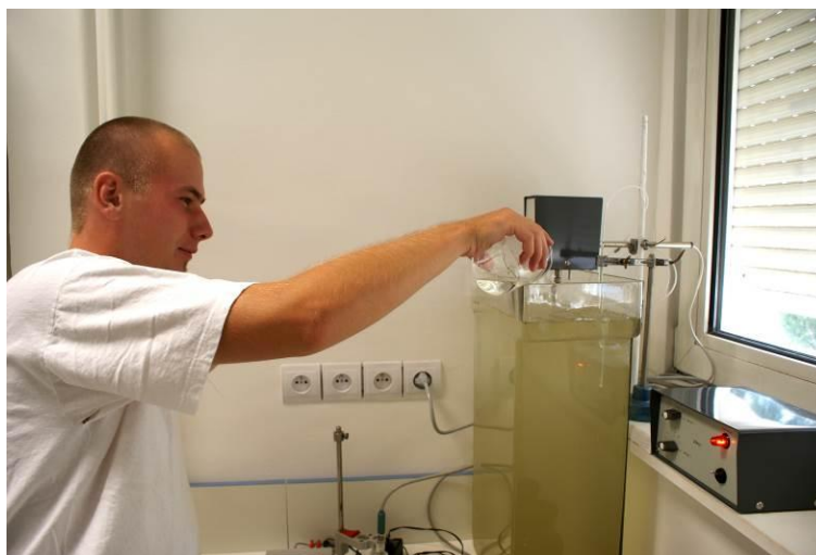
pri biotechnologických procesoch je potrebné sledovanie teploty v rôznych častiach reakčnej nádoby, bezkontaktný spôsob je v tomto prípade ideálny
