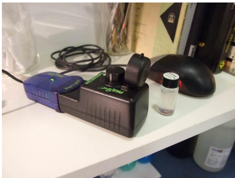
turbidimeter v prevádzke
