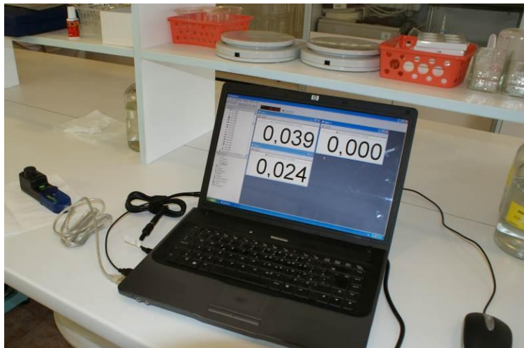
meranie absorbcíí, pri rôznych vlnových dĺžkach súčasne
