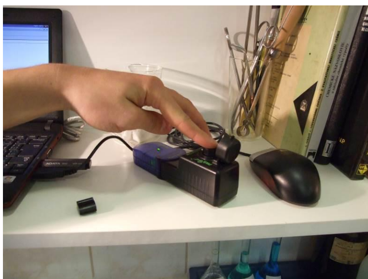
dôležité je správne umiestnenie kvetky, ktorá sa musí pred meraním očistiť
