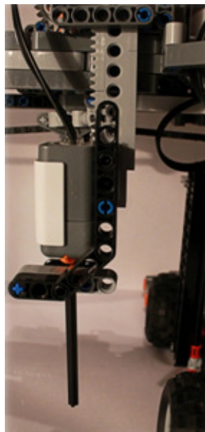
Obrázok 11 Detail navrhnutého mechanizmu pre posun sondy vo vertikálnom smere Prameň: archív E-team Robotics*SK
