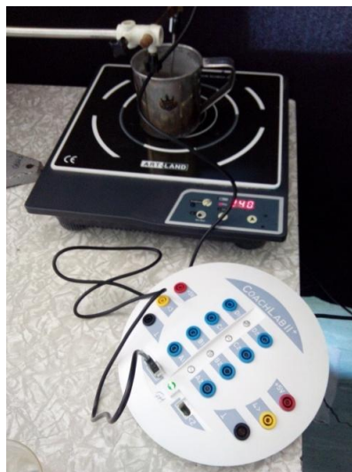
Obrázok 6 Určovanie teploty varu minerálnej vody
