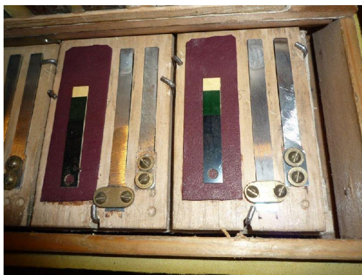
Obrázok 3 Basové hlasy s dvojitými jazýčkami a klapkami
