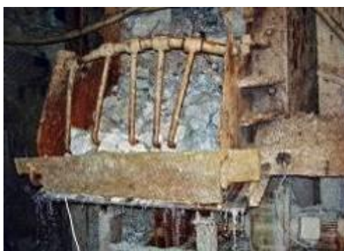
Obrázok 123: Surovina pripravená na nakladanie do vozíkov. Jednoduché zábrany - zuby zabraňujú rýchlemu pohybu väčšej časti vyťaženej horniny mimo vozíka.
