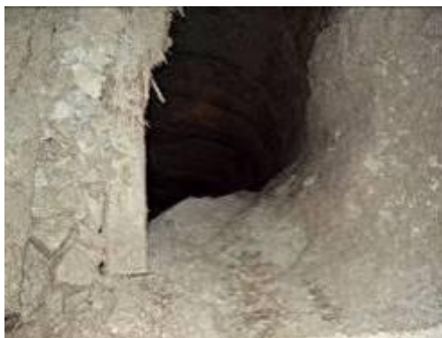
Obrázok 112: Pohľad do zvislého banského diela (tzv. komína), kam sa sype surovina na ďalší presun, aby sa potom dala vyvieť z bane
