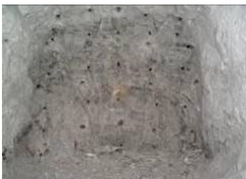
Obrázok 121: Navrtná čelba (čelná plocha razeného banského diela) v procese razenia banského diela pripravená na nabíjanie trhavinou (pred jej nabíjaním)
