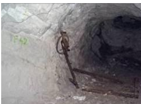
Obrázok 120: Vrtné kladivo VK-22 s pneumatickou podperou. Je určené hlavne na razenie banských diel krátkymi vrtmi. V bani Hnúšťa - Mútnik sa ním robili vývrty dlhé 1,2 m.
