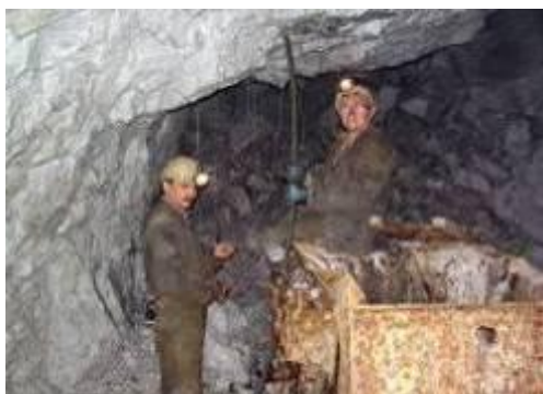
Obrázok 126: Zamestnanci bane, ktorí nabíjajú strelné vrty strelivom. Na fotografii sú viditeľné trčiace káble do rozbušiek.
