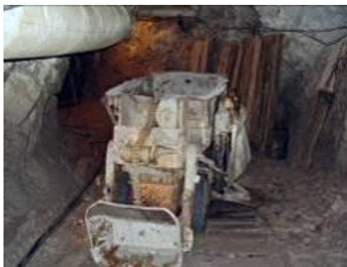
Obrázok 113: Vzduchový nakladač v štandardných podmienkach je schopný vybrať aj zatáčky, lebo je na vlastnom podvozku (nie na koľajniciach). Má aj vlastnú vyklápačnú korbu.
