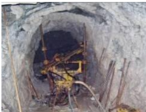
Obrázok 116: Vrtná súprava značky BISON, ktorou sa vrtajú vejáre (vrty vejárovitého tvaru) až do hĺbky 30 metrov
