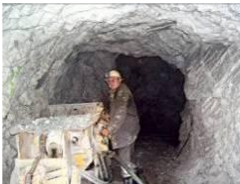
Obrázok 114: Obsluha nakladača stojí na stúpačke a ovláda ho pomocou dvoch pák. Ľavou pákou usmerňuje otáčanie kolies dopredu alebo dozadu. Pravou pákou riadi pohyb lyžice (nakladanie). Nakladač sa najskôr rozbehne do suroviny, naberie ju lyžicou a potom ju preklopí do korby.
